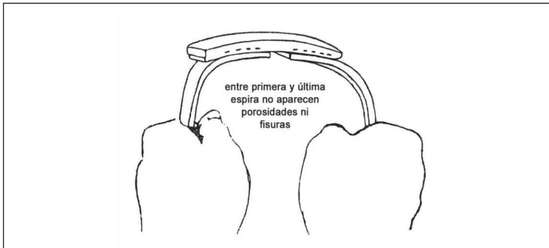
**C. Ensayo destructivo en obra de desprendimiento por falla de adherencia en electrofusión.**
